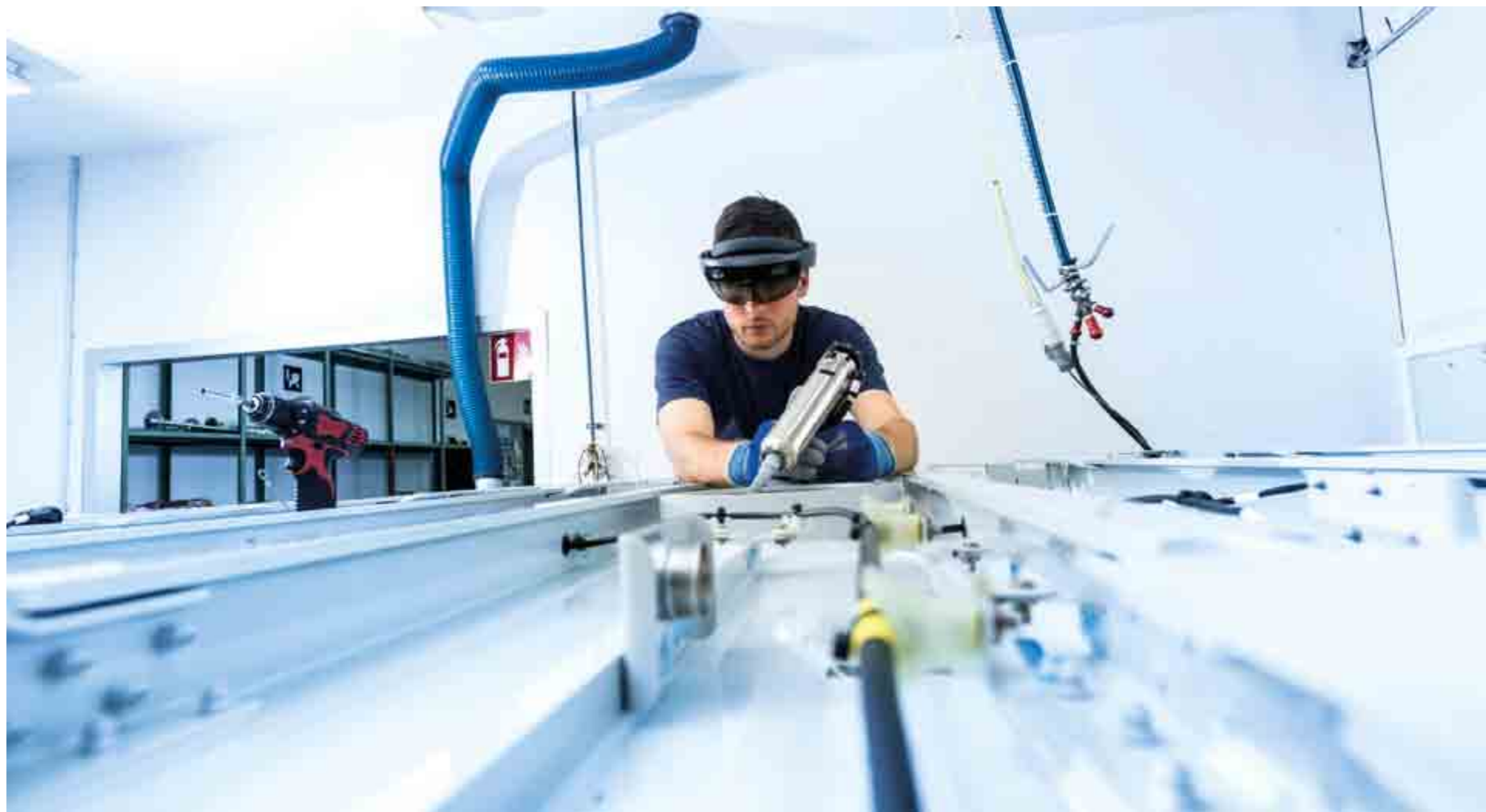
Bei der Montage von Bauteilen benötigen Techniker oft beide Hände. Eine Brille mit Augmented Reality kann Bedienungsanleitungen direkt im Blickfeld anzeigen
