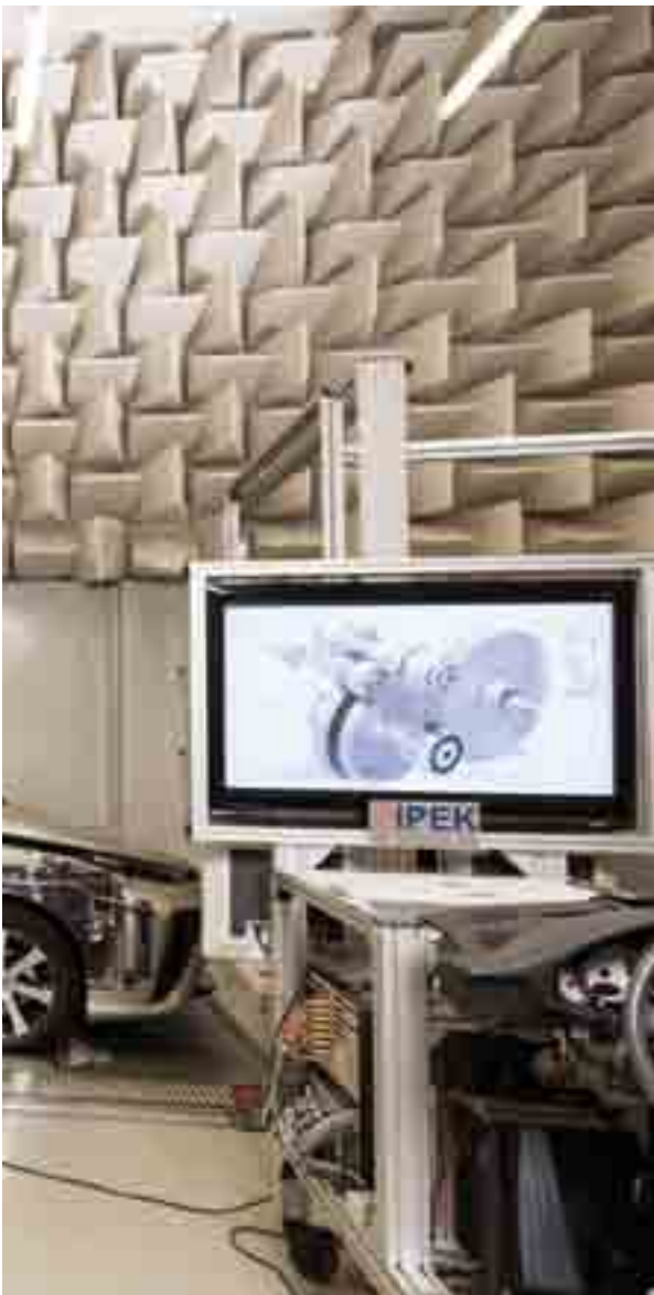
Ein Antriebssystem in einem Fahrzeug kann auf dem Rollenprüfstand am KIT zum Einsatz kommen, während der Fahrer auch in China sitzen kann
