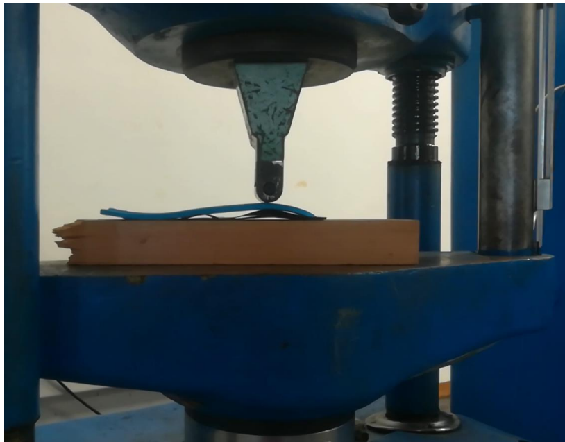
Figura 35. Ensayo a compresión plantilla mallado longitudinal [Autores].
