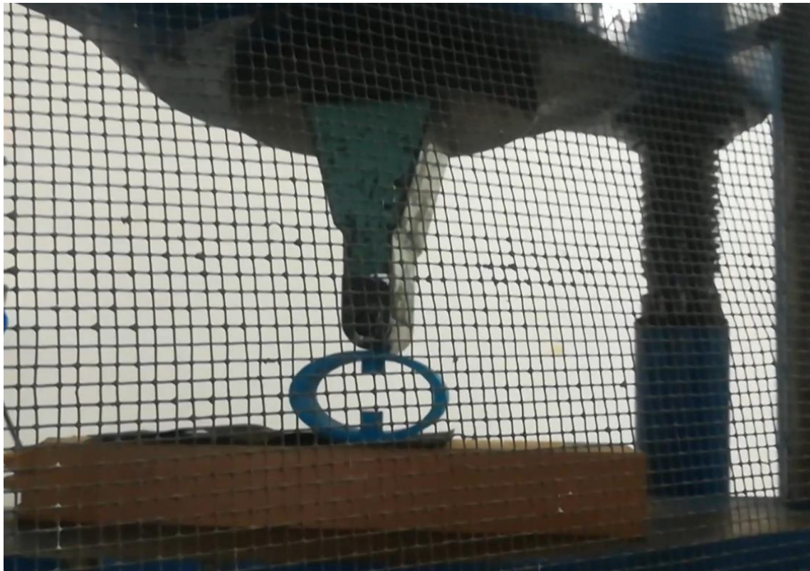
Figura 29. Ensayo a compresión anillo elíptico densidad 70 [Autores].
