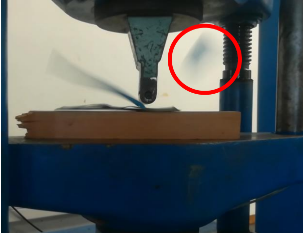
Figura 36. Ruptura de la plantilla mallada longitudinal [Autores].
