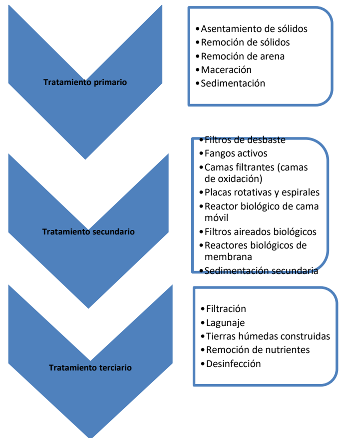
Figura 1: Etapas de Tratamiento del Agua Residual doméstica.
