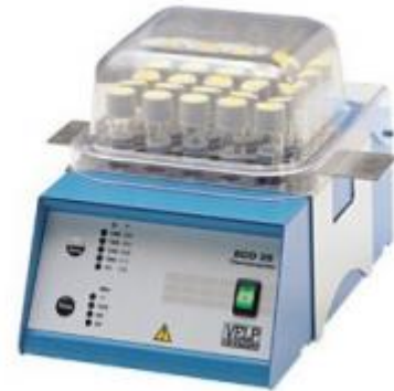
Imagen 2. Equipo Digestor termoreactor Velp Científica Eco 25, utilizado para análisis de DQO.
