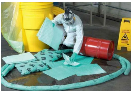
Figura 12.4.1. Contención de líquidos empleando anillos colchas y mantas absorbentes.
