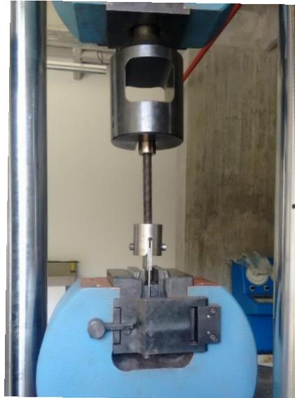
Figura 18. Montaje para el ensayo de tracción
