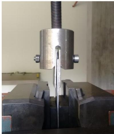
Figura 17. Elemento de sujeción
