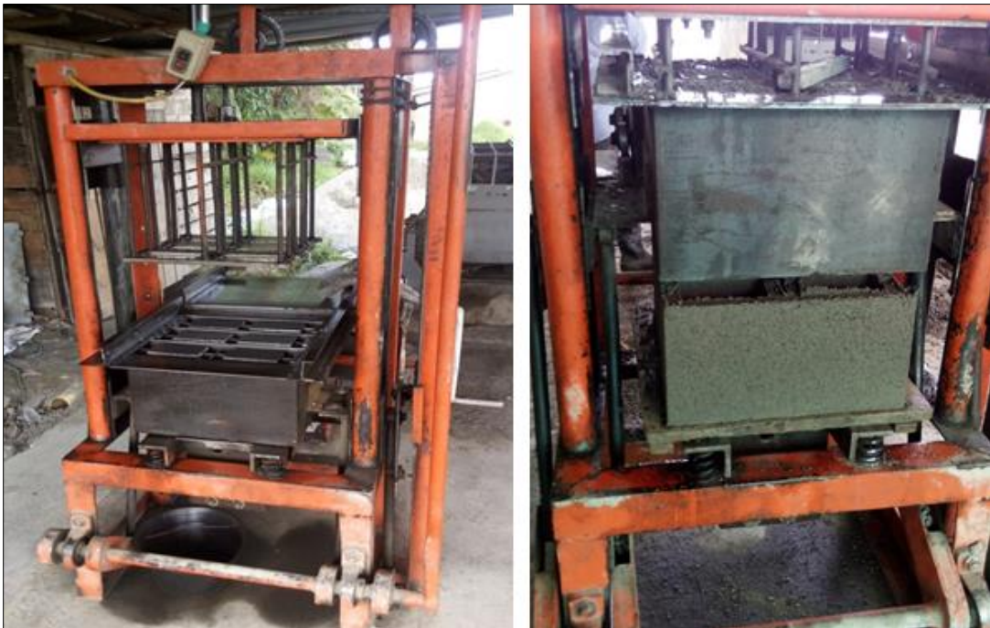
Figura 9. Máquina bloquera y desmolde de un bloque terminado.
