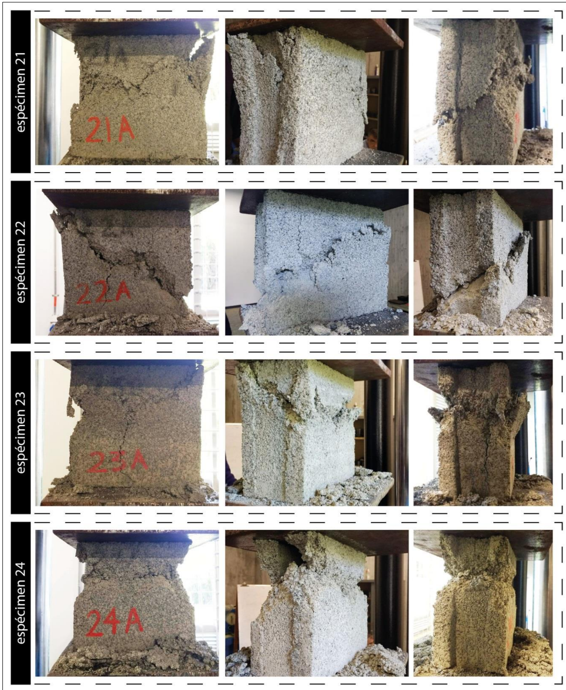
Figura 25. Fotografías del modo de falla concerniente a los especímenes de la mezcla 2.
