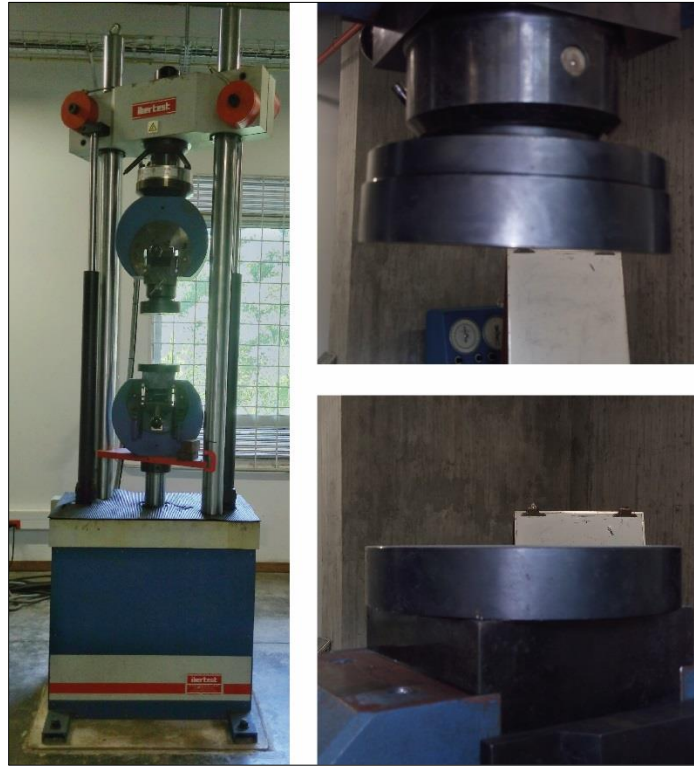
Figura 16. Máquina Universal de Ensayos y sus aditamentos para compresión.
