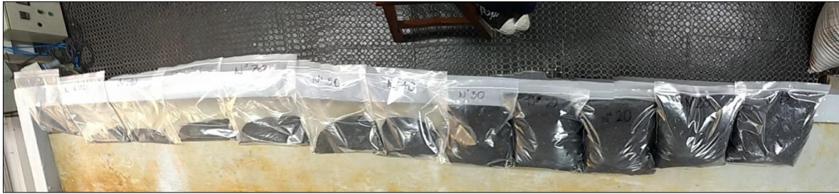
Figura 2. Cantidad de neumático retenida en cada tamiz.
