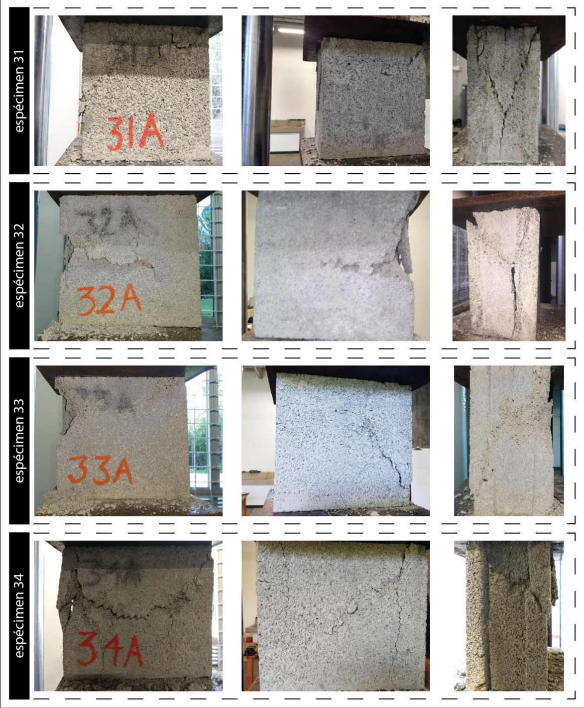
Figura 26. Fotografías del modo de falla concerniente a los especímenes de la mezcla 3.
