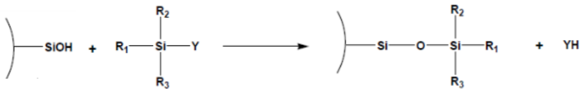
Figure 30 : Fonctionnalisation des groupements silanols de surface par des silanes
