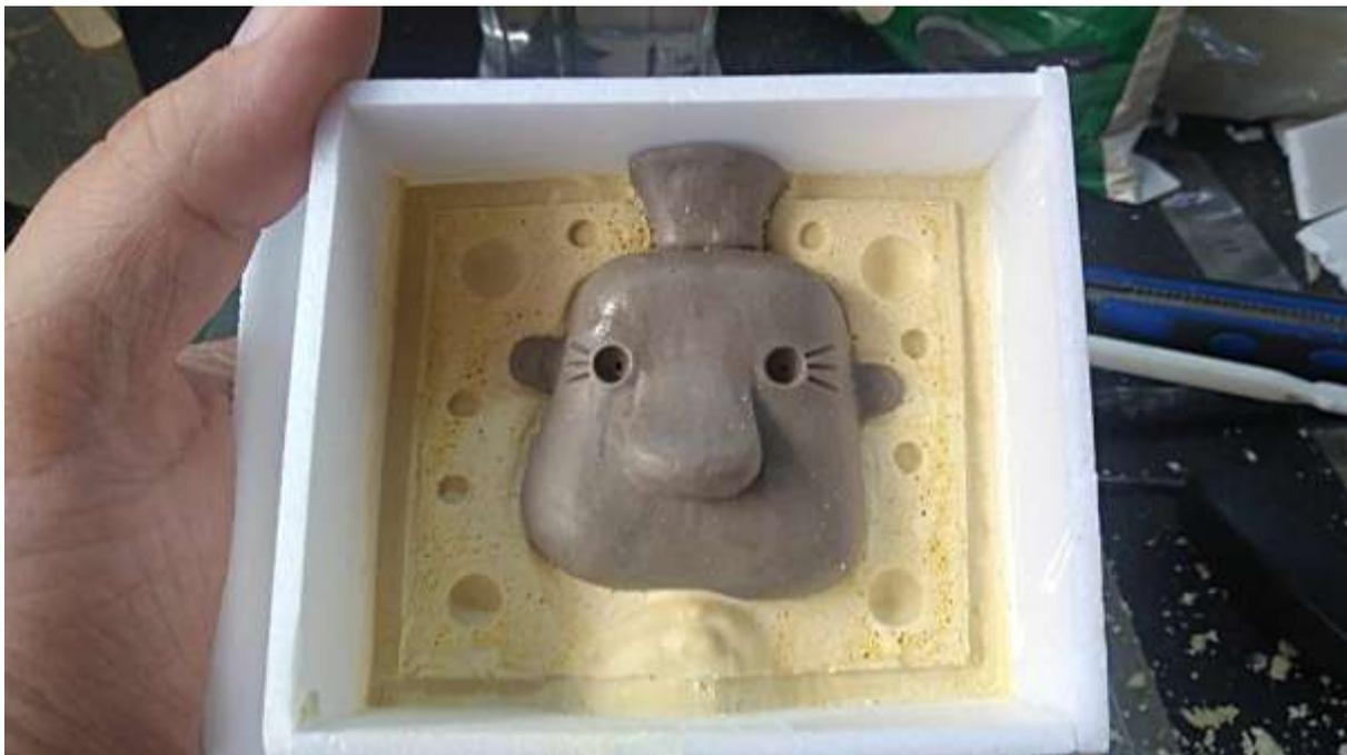
*Figura 28 – Detalhe de molde em gesso da cabeça modelada em Clay, foto de acervo do autor.*
