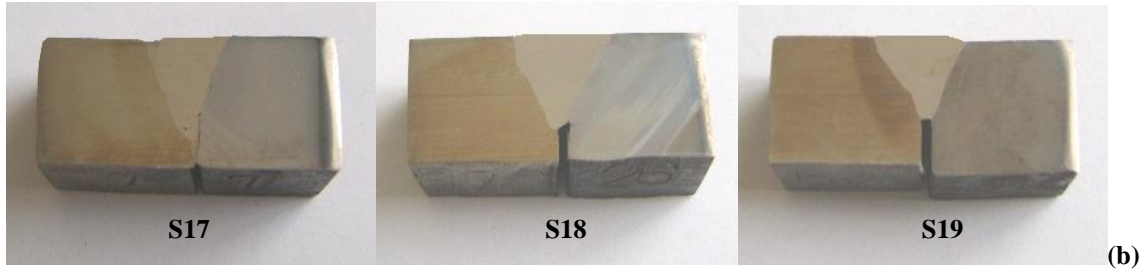
Şekil 4.7.a) S17, S18 ve S19 No' lu numunelerin kaynak yüzey makro görüntüsü b) S17, S18 ve S19 No' lu numunelerin kaynak arayüzey makro görüntüsü (I= 135 A V= 0.01, 0.02, 0.03 m/dak. D= 1.2 lt/dak. d= 2.4 mm)
