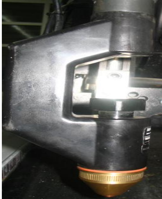
Şekil 3.3. Deneylerde kullanılan plazma kaynak ünitesinin resmi
