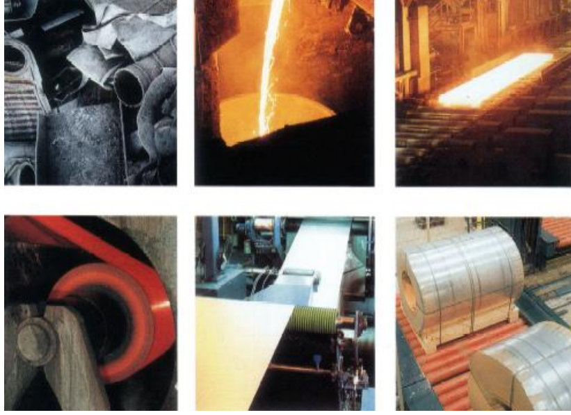
Şekil 2.3. Paslanmaz çelik üretim aşamalarından bazı görüntüler (Aran, 2003).
