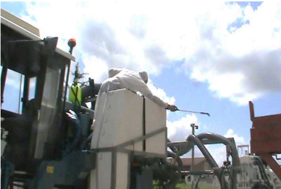
Figura 11: Echando agua comprimida a diferentes partes del tractor pulverizador
