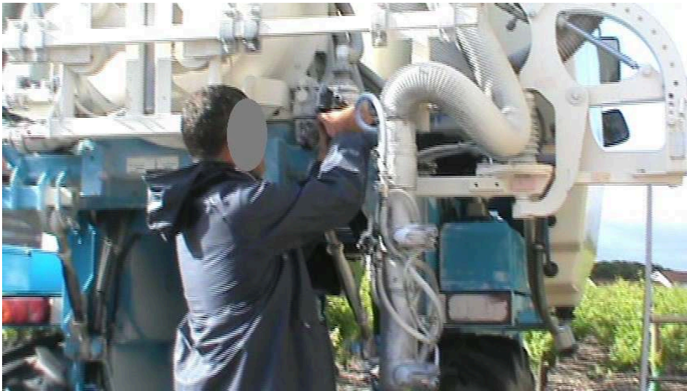
Figura 6: Retiro de filtros
