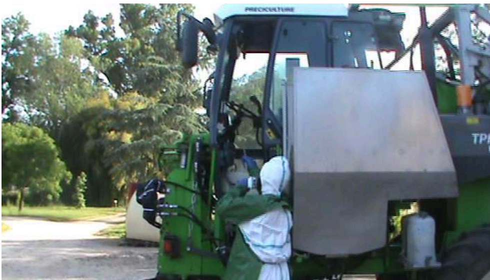
Figura 7: Utilización de un palo para acceder a los comandos
