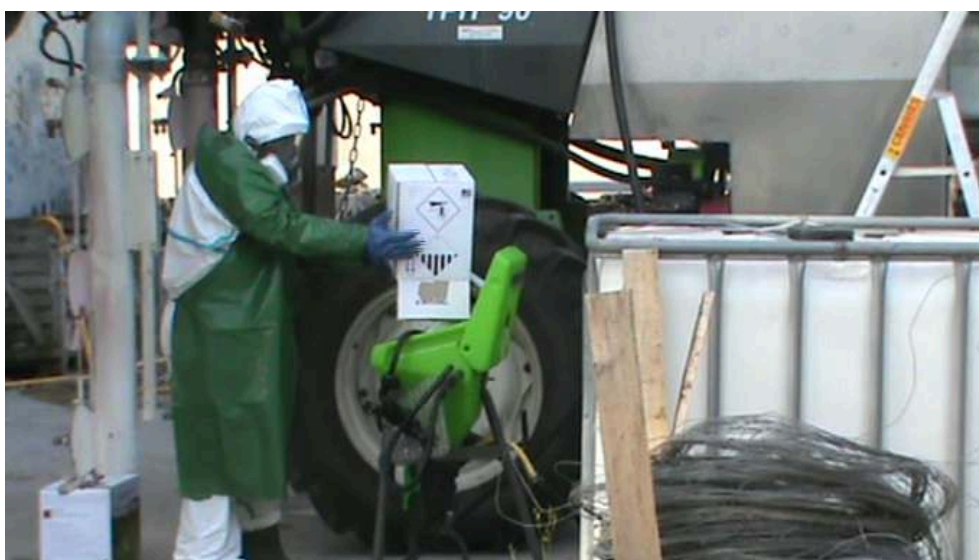
Figura 12: Adicionado los pesticidas a un incorporador
