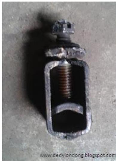
Gambar 56. Kontaktor dengan model jepit pada konektor
