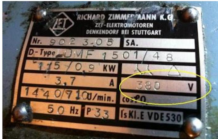
Gambar 25. Contoh gambar name plate motor 380V
