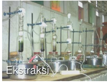
Gambar 14 Proses ekstraksi dengan refluks Sumber gambar: https://s3.amazonaws.com
