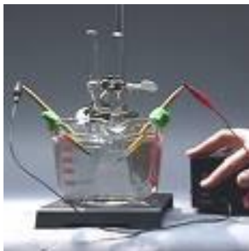
Gambar 15 Elektrolisis pada gravimetri Sumber gambar : http://4.bp.blogspot.com
