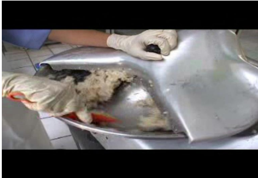
Gambar 18 Membuat adonan bakso dengan silent cutter
