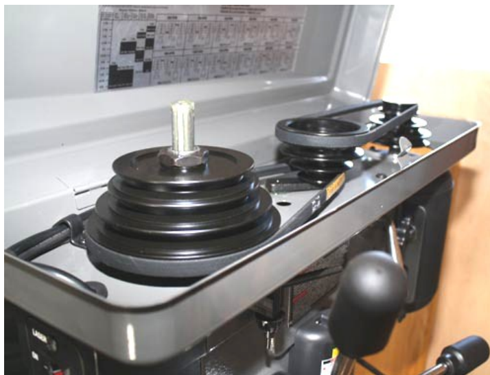
Gambar 12.6 Transmisi bor 12 tingkat kecepatan
