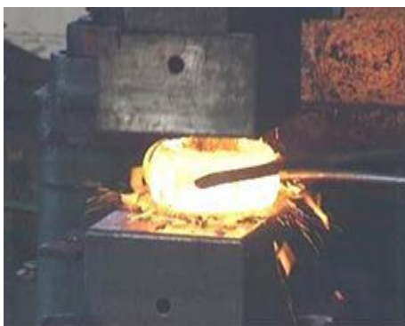
Gambar 9.57. Proses tempa dengan mesin Hammer
