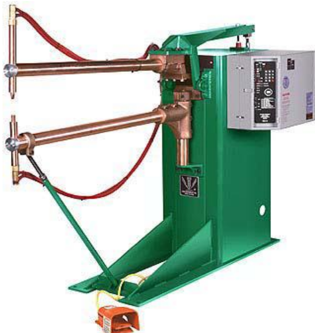
Gambar 5.2 las resistansi titik dengan penggerak tuas tangan
