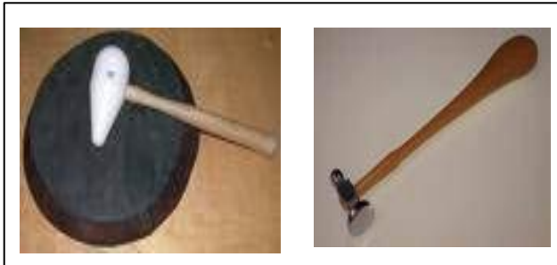
Gambar 9.14. Palu kayu tirus & palu rata mangkuk-mangkuk dari bahan alumanium.
