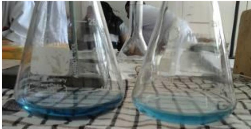
Gambar 12. Warna titik akhir titrasi kompleksometri menggunakan indikator EBT
