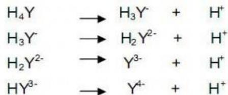
Sebagai penitrasi/pengomplek logam, biasanya yang digunakan yaitu garam  $\text{Na}_2\text{EDTA}$  ( $\text{Na}_2\text{H}_2\text{Y}$ ), karena EDTA dalam bentuk  $\text{H}_4\text{Y}$  dan  $\text{NaH}_3\text{Y}$  tidak larut dalam air.
