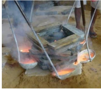
Gambar 2 Menuang logam cair pada cetakan Sumber: http://www.coroflot.com
