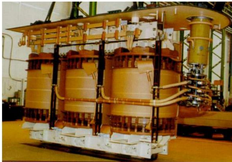
Gambar 2.16. Transformator (Sumber: https://lumbanrajateddy.wordpress.com )
