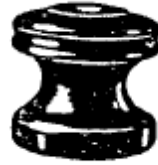
Gambar 25. Konstruksi isolator jenis cincin
