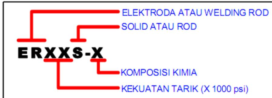
Elektroda untuk pengelasan MIG ( *metal inert gas* ) mempunyai berbagai jenis atau model elektroda ( kawat elektroda ). Hal ini disebabkan pengelasan menggunakan las MIG ( *metal inert gas* ) banyak sekali dibutuhkan tidak hanya untuk pengelasan baja karbon saja melainkan juga di gunakan untuk pengelasan *stainless steel* maupun *aluminium*.
