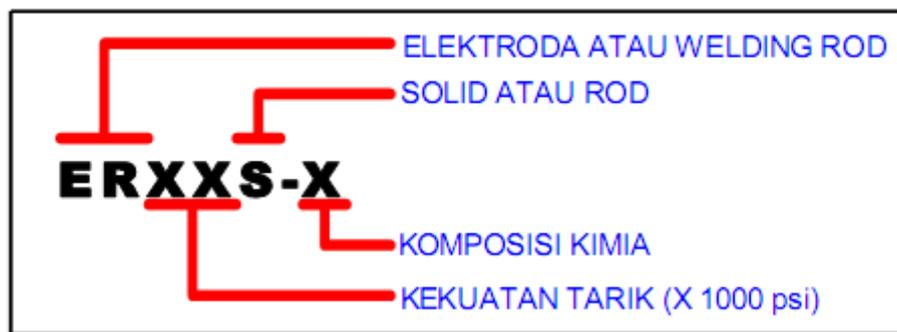
Gambar 26. {engkodean kawat elektroda GMAW
