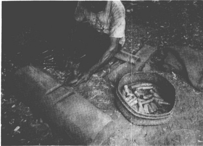
Pembuatan cincin parang (dari besi / belahan drum)
