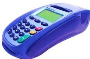
Mesin yang digunakan untuk melayani konsumen yang melakukan pembayaran non tunai/ alat pembayaran elektronik adalah mesin EDC (*Elektronik Data Captures*).
