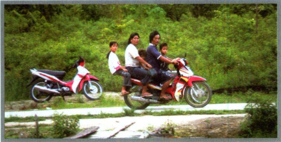
*Gambar 8: Memanjangkan tempat duduk motor untuk mengangkut penumpang lebih banyak*
