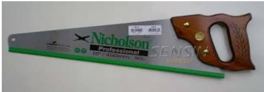
Gambar 19. Gergaji tangan yang digunakan untuk membelah atau memotong kayu (fjb.kaskus.co.id)
