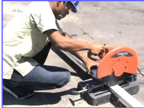
Gambar 1.36. Proses Pemotongan Baja Batangan Sumber : Dokumentasi PT. Fenejo Mitra Prima, 2015
