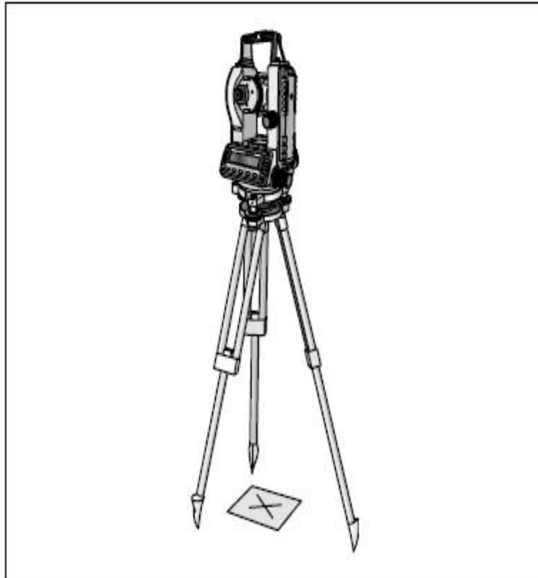
Gambar 1.29. Pengecekan optical plummet
