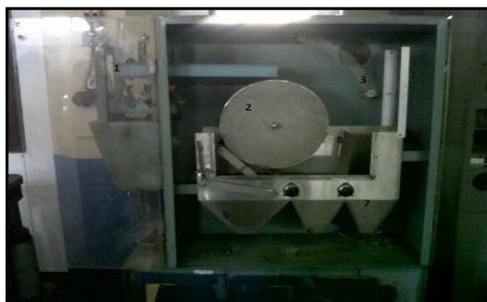
**Gambar 24. Bagian dari Electrostatic Separator**
