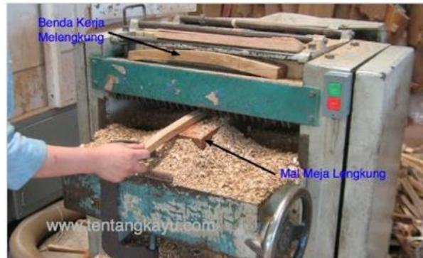
Gambar 5.18. Contoh Mengetam Lengkung dengan Mesin Ketam Penebal
