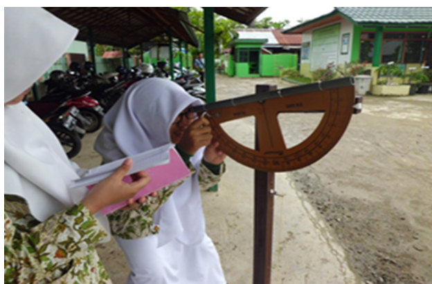
Gambar 10. Seorang Siswa sedang Menggunakan Klinometer
