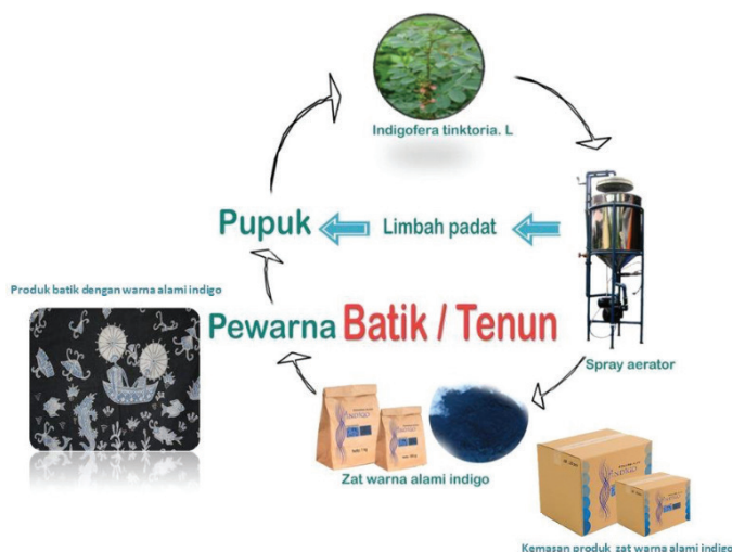
Gambar 2.19 Pola integrasi tekno-ekologis pada pembuatan zat warna alam indigo
