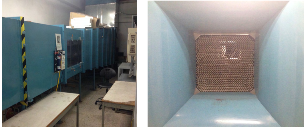
Figura 53. Túnel de viento del laboratorio de arquitectura bioclimática (izquierda) y la tobera de entrada del túnel (derecha).
