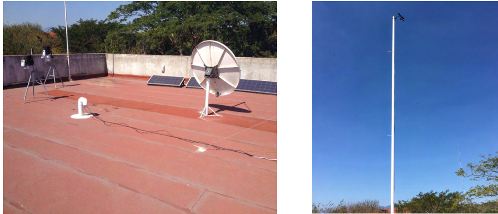
Figura 60. A la izquierda se puede observar la azotea del laboratorio de ciencias de la energía eólica de la UNISTMO, a la derecha el anemómetro con el que se medirá la velocidad de viento.
