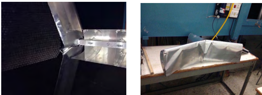
Figura 56. Aspa que sufrió el accidente al tocar una pared de túnel.
