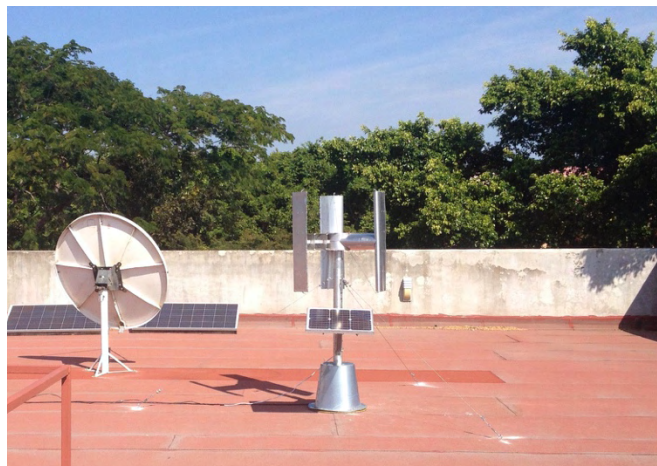
Figura 62. Luminaria después de la prueba piloto de resistencia por una semana.
