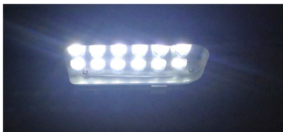
Figura 64. Lámpara de la luminaria eólico-solar en prueba de 11 horas de funcionamiento continuo dentro del laboratorio.
