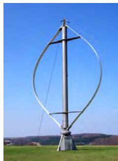
Figura 6. Turbina tipo Darrieus con curva tipo Troposkien de 5m de diámetro.
