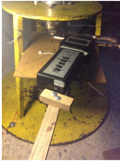
Figura 59. Montaje del freno prony en el eje del rotor eólico.
