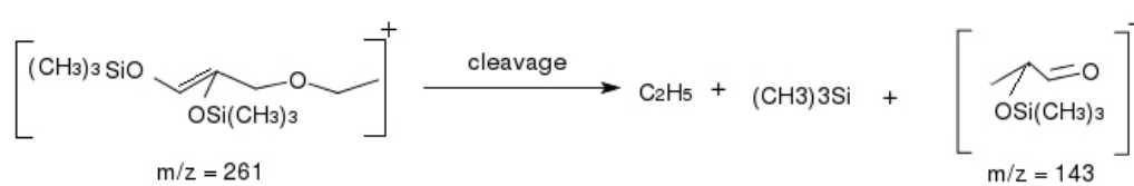
Figure 6.18: Transition of 261 Da EtG-BSTFA fragment to 143 Da.
