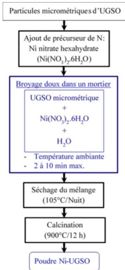
Figure 3.3. Schéma bloc de la préparation du Ni-UGSO par réaction à l'état solide améliorée [11].
