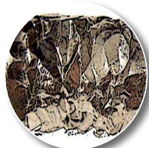
Figura 33. Zirconio en su estado natural. Luego de reducir el tamaño, se puede lograr el efecto abrasivo.
