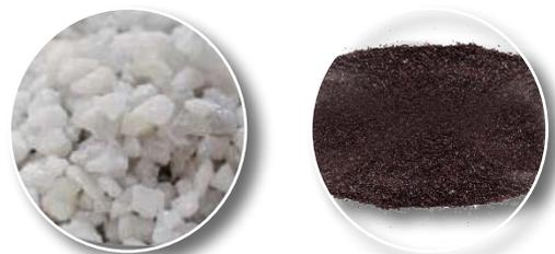
Figura 34. Alúmina en su estado natural. Este mineral es abrasivo y tiene propiedades intermedias entre la sílice y el diamante.
