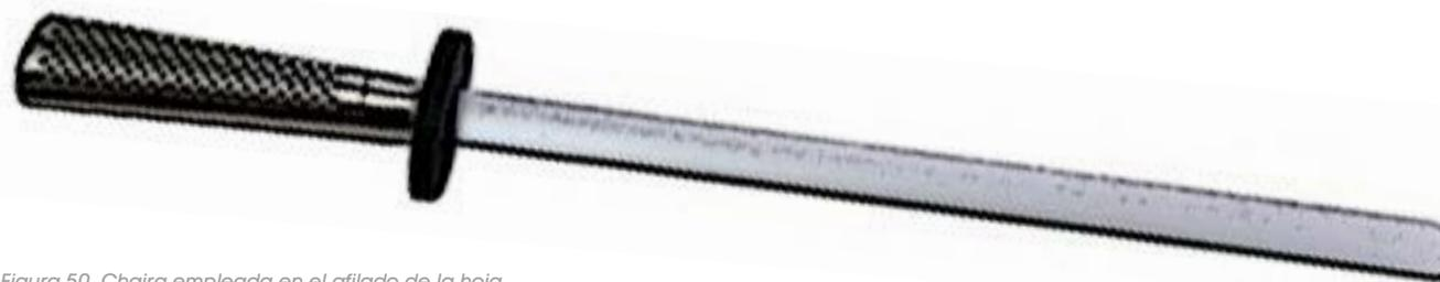
Figura 50. Chaira empleada en el afilado de la hoja metálica de la lámina de las cuchillas empleadas en el corte manual en la industria del cuero.
