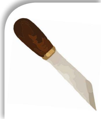
Figura 62. Chifla inglesa empleada para el corte artesanal del cuero en Inglaterra.
