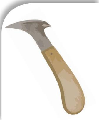
Figura 66. Cuchilla combinada comercial, versátil herramienta empleada para el trabajo de varios materiales empleados en la industria del cuero.
