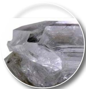
Figura 37. Imagen de un diamante sintético empleado como material abrasivo para el pulido de superficies metálicas.
