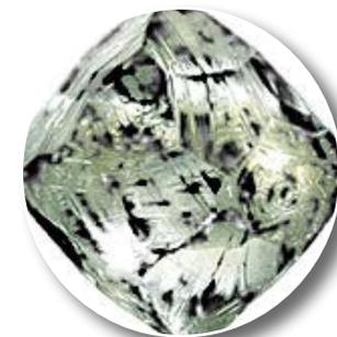
Figura 32. Diamante en su estado natural. Este mineral deberá ser reducido hasta tamaños muy pequeños para poder lograr un buen efecto abrasivo.
