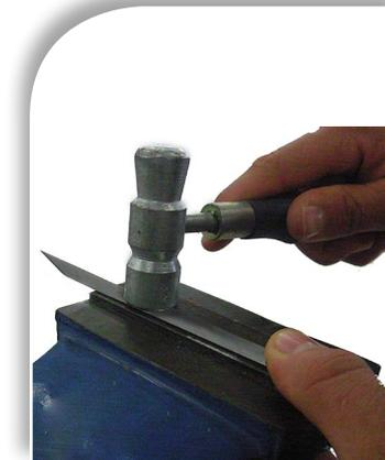
Figura 11. Cuchilla elaborada mediante el proceso de forja en frío, empleada para el corte manual en el sector del cuero.
