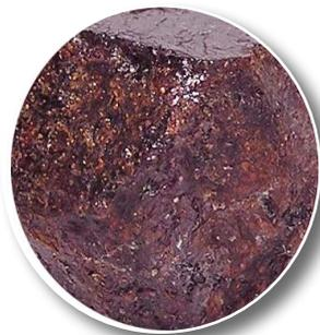
Figura 30. Granate en su estado natural. Luego de reducir de tamaño este mineral, se puede lograr el efecto abrasivo
