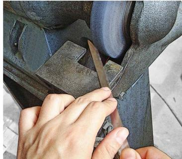
4. Luego se ubica la lámina de acero en el soporte del esmeril para eliminar o desbastar el material que sobra a partir de la línea marcada y así lograr el ángulo de corte (figura 91).
