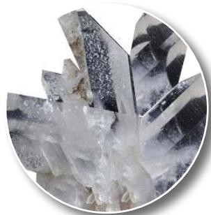
Figura 29. Cuarzo en su estado natural conocido comercialmente como sílice. Luego de reducir de tamaño el mineral, se puede lograr el efecto abrasivo.
