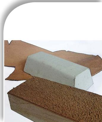
Figura 52. Esquema de asentado de una hoja de cuchilla sobre una superficie de cuero para aplanar la hoja metálica de las cuchillas empleadas en el corte manual en la industria del cuero.
