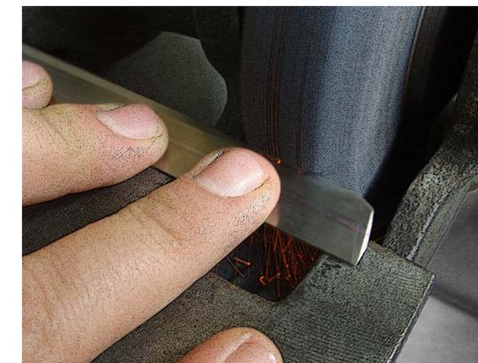
2. Con la ayuda de un esmeril eléctrico se le da forma desbastando el anterior filo de la lámina o los dientes de la seguenta, hasta obtener el ancho deseado (figura 89)
