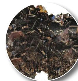
Figura 35. Imagen de carburo de silicio sintético empleado como material abrasivo para el pulido de superficies metálicas.
