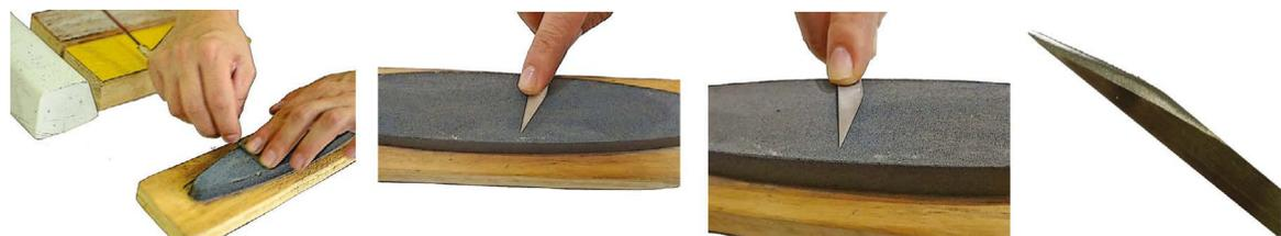
Figura 94. Proceso de afilado de una cuchilla artesanal empleada para el corte manual en el sector del cuero
