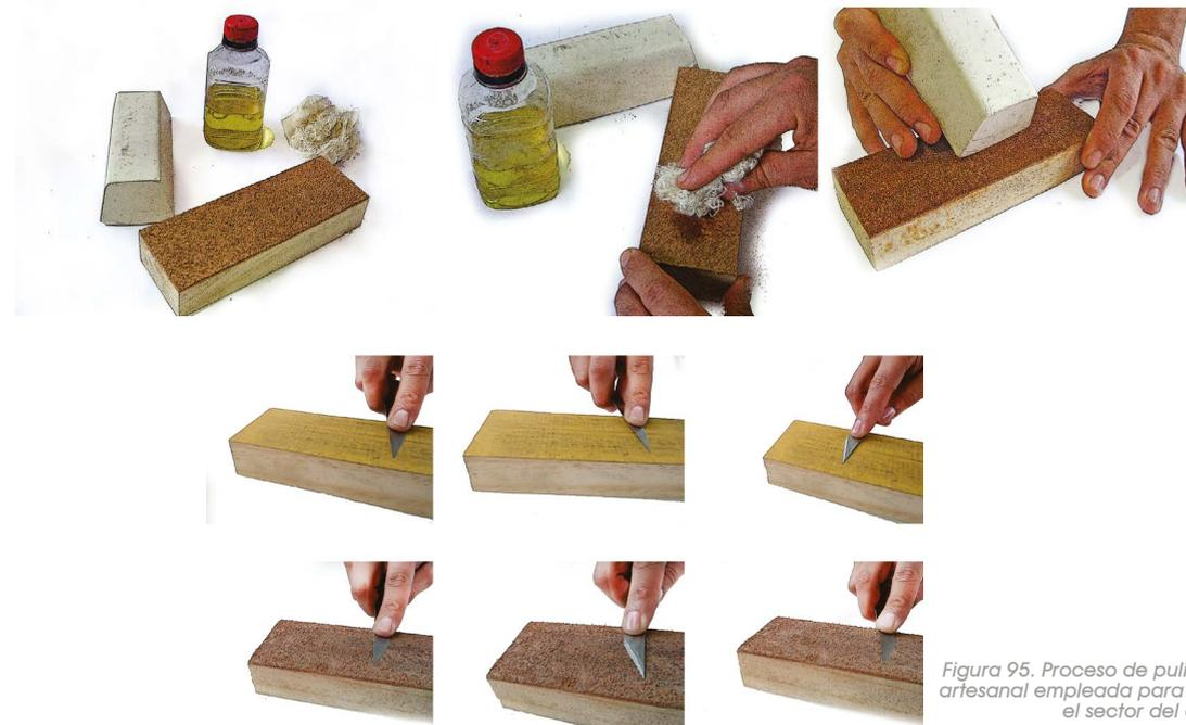
Figura 95. Proceso de pulido de una cuchilla artesanal empleada para el corte manual en el sector del cuero.
