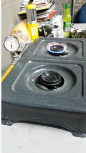
**Figura 2.4.** Estufa marca Abba de dos quemadores. Potencia de 3,26 kWh.
