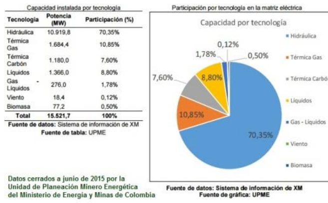
Figura 143: Potencia Instalada y cuota de Generación en el mix. Fuente: Sistema de Información Eléctrico Colombiano, Boletín, 2012-2015.
