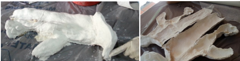
Figura 2. Elaboración del contra molde de yeso. Fuente: Autores
