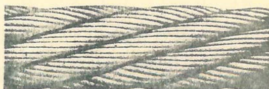
TRENZADO REGULAR A LA IZQUIERDA: Los alambres en los cordones están trenzados hacia la derecha y CADA cordón se coloca o trenza hacia la izquierda, como se muestra en la figura.
