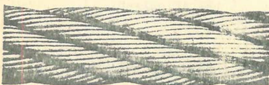
TRENZADO REGULAR A LA DERECHA: Los alambres en los cordones están trenzados hacia la izquierda y CADA cordón se coloca o trenza hacia la derecha, como se muestra en la figura.
