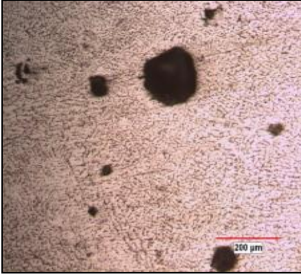
Şekil 5: Manuel 90A ve 5.0112 kJ/cm ısı girdisinde kaynak metalinin mikroyapısı.
