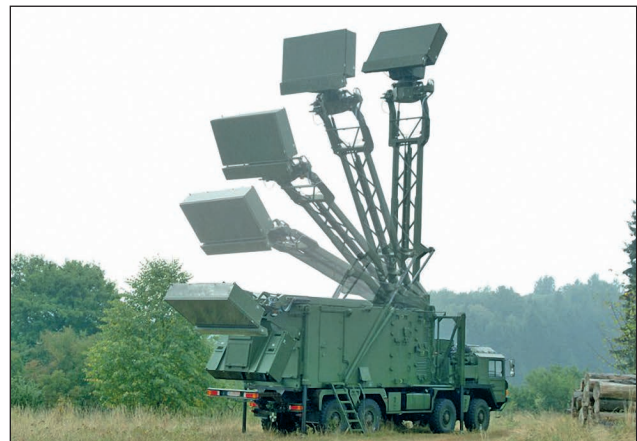
3. ábra. A TRML-3D radar antennarendszerének telepítése
