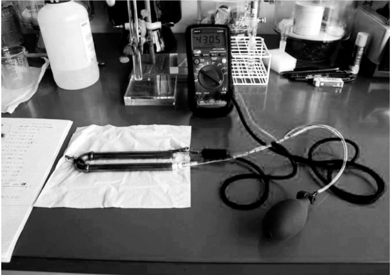
Abb. 3: Potentialmessung mit dem elektrochemische Sensor (Inset) zur Bestimmung des Korrosionszustands im Innern der Instrumente. Ein kleiner Ballon, der mit der schwarzen Pumpe von aussen gefüllt wird, drückt den Sensor an das Metall.
