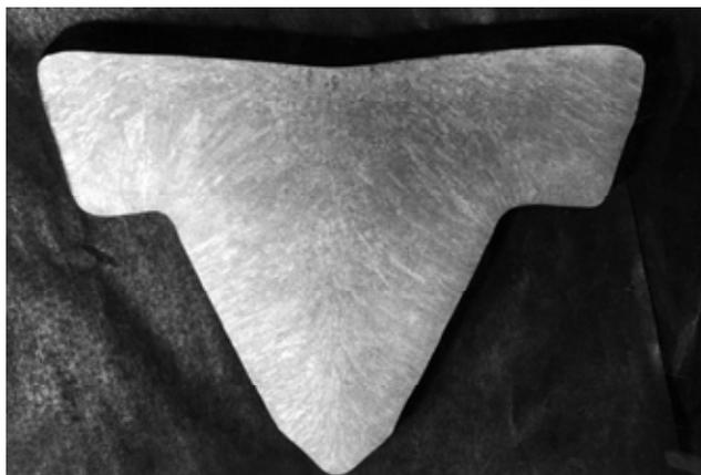
Рис. 4. Макроструктура рассекателя, имеющая транскристаллитное строение,  $\times 0,5$
