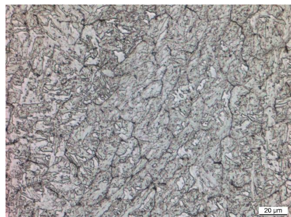
f) Mn 4 Ni 2 CrMo + 6 μm niobium middle layer
