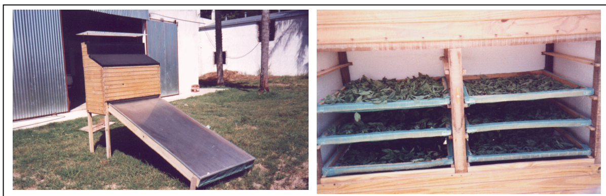
Figura 2: Vista del secadero solar y detalle del interior de la cámara de secado.
