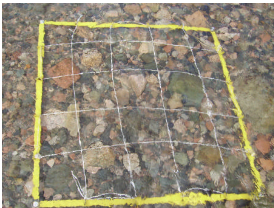
Figura 20: Fotografía de la grilla ( 1 \text{ m}^2 ) colocada en la sección muestreada en el mes de mayo de 2005. Cada celda mide aproximadamente 20 \times 20 \text{ cm} .
