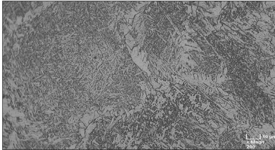
Fig. 7. Estimation of grain size in WMD with 2% Ni, 55% of acicular ferrite, 3% of MAC, 200× Rys. 7. Szacowanie wielkości ziaren w stopiwe elektrodowym zawierającym 2% Ni, 55% drobnoziarnistego ferrytu, 3% faz MAC, 200×
