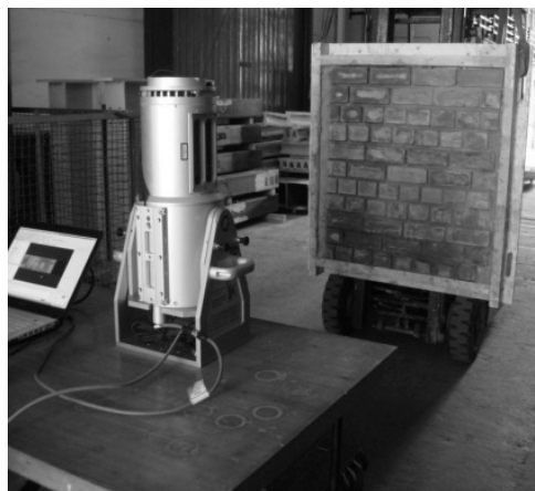
Fig. 5. The 360° overview scanning process of model 1 (bricks & mortar), at 2m Rys. 5. Przedstawienie procesu skanowania 360° do modelu 1 (cegły i zaprawy) w 2m
