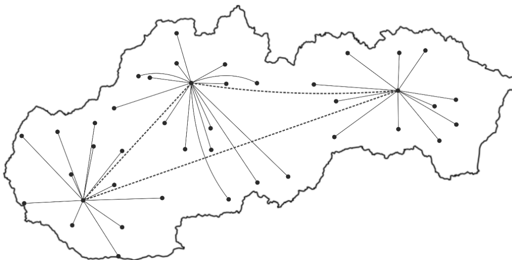
Fig. 2. High-level nodes with covered demand nodes for obtained solution Rys. 2. Węzły wysokiego poziomu dla otrzymanego rozwiązania
