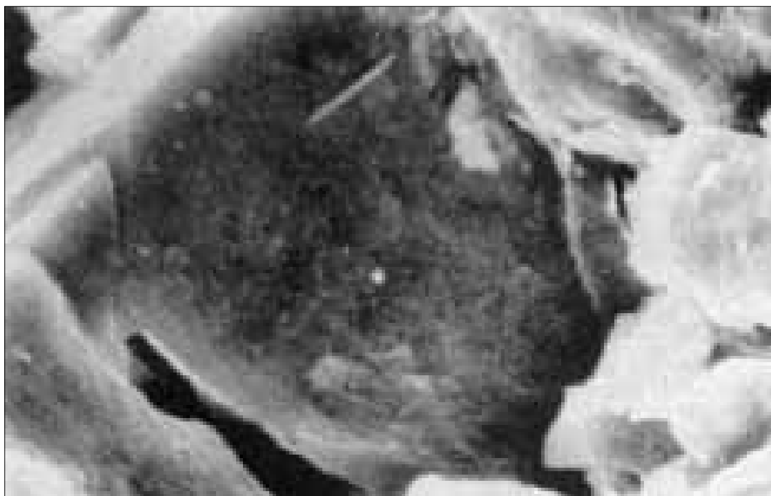
Slika 9.5 Ravnomerno naprsli zidove nagoveštavaju naprsline kao posledicu metal-jonski uzrokovane oksidacije [20]
