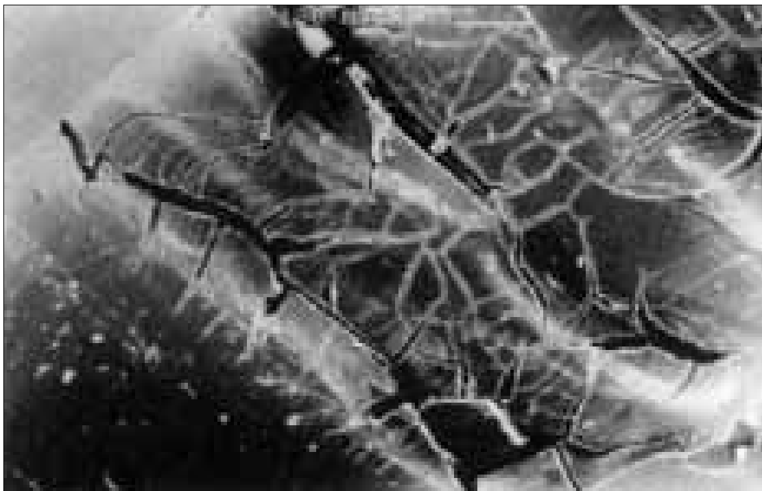
Slika 9.6 Deo pukotine na unutrašnjem lumenu polietarne uretanske izolacione žice pratećeg namotaja kod metal-jonski uzrokovane oksidacije ( \times 100 ) [20]
