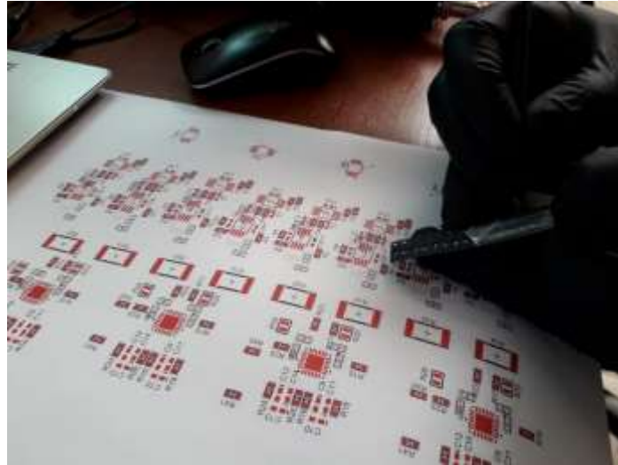
Figura B.6: Reconocimiento de elementos en la hoja de suelda
