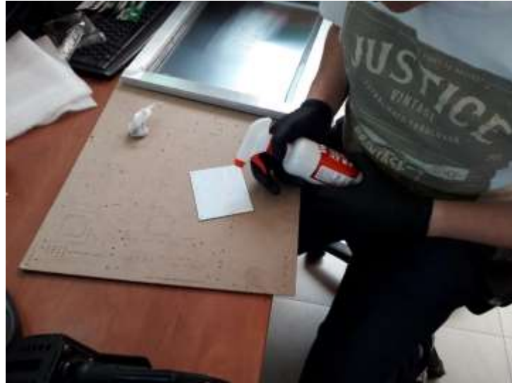
Figura B.1: Limpieza del PCB previa suelda de elementos
