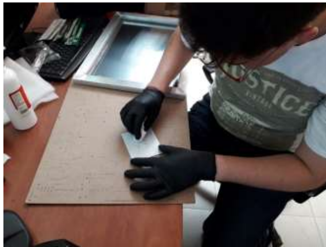
Figura B.2: Remoción de cuerpos sólidos y pulido de pads expuestos
